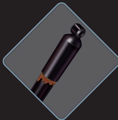
Si presenta fugas Reemplazar
